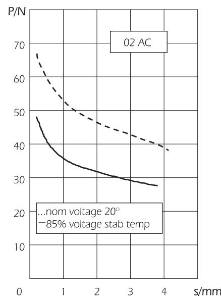
**切換性能極限 (在  $v = 41 \text{ mm}^2/\text{s}$  and  $t=50^\circ\text{C}$  時測得)**
